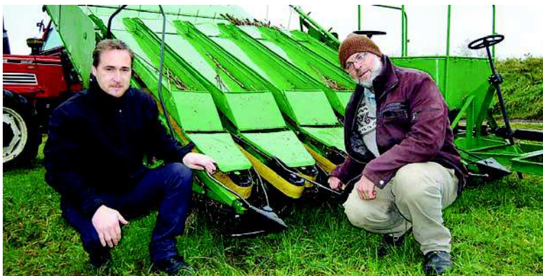
Jožef Bonifart in Dejan Rengeo sta združila moči pri iskanju rešitev za spravilo industrijske konoplje. Snopovezalna na fotografiji je le eden izmed prilagojenih strojev v celotni liniji. FOTOGRAFIJA CIRIL KOSEDNAR
